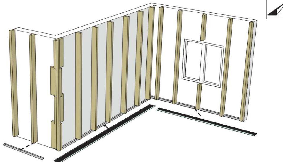
Installez les ossatures verticales. Installez ensuite les profilés perforés sur le dessous et près d'une ouverture sur la façade. Installez les profilés perforés en prévoyant un espace de ventilation d'au moins 200 cm<sup>2</sup> par m<sup>1</sup>.
