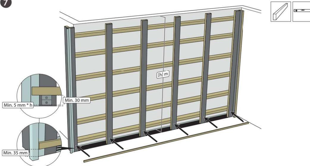
Fixez un niveau à bulle ou une latte de montage avec des serre-joints à une hauteur minimale de 35 mm sur les ossatures verticales. Vous pouvez aussi utiliser un niveau laser pour projeter une ligne.
