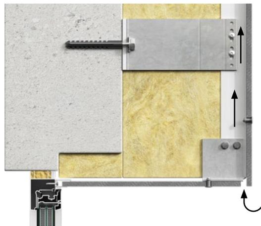
Ebenso muss eine Lüftungsöffnung über Fenstern und Türen eingehalten werden. Dieser Spalt muss mindestens 10 mm breit sein. Werden Lüftungsprofile verwendet, wird ein Belüftungsquerschnitt von mindestens  $50 \text{ cm}^2$  pro Meter benötigt. Durch diese Öffnung kann auch Diffusionsfeuchte und Tauwasser abgeleitet werden.
