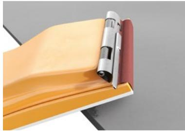
Nach dem Zuschnitt können die Kanten mit einem Schleifpapier gebrochen werden. Die Fasse sollte einen 45° Winkel aufweisen. Das verleiht der Tafel Stabilität und kaschiert evtl. Ausbrüche.
