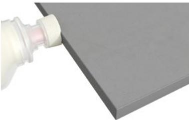
Alle Schnittkanten (außer Patina Designline) müssen mit Cembrit Kantenversiegelung versiegelt werden um den Schutz der Schnittkanten zu gewährleisten. Benutzen Sie die Kantenversiegelung mit einem Applikator. Vermeiden Sie den Kontakt der Flüssigkeit mit den Oberflächen der Tafeln. Sollte dies passieren, entfernen Sie umgehend die Flüssigkeit mit einem flusenfreien Tuch.
