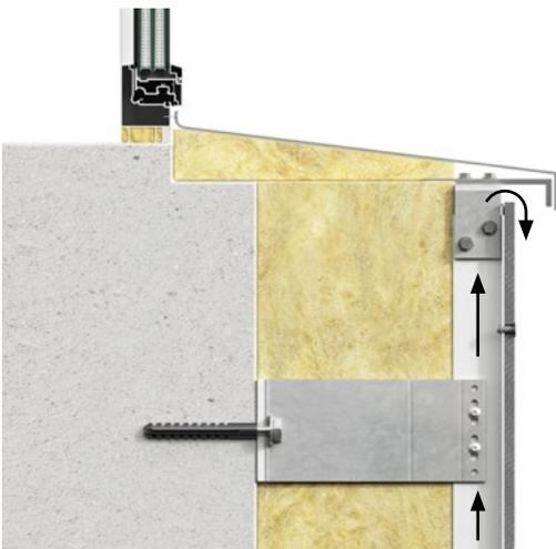
Unter den Fensterbänken ist ebenso ein Mindestabstand von 10 mm oder  $50 \text{ cm}^2$  einzuhalten. Der Lüftungsspalt wird zwischen der oberen Kante der Fassadentafel und der Unterkante Fensterbank gebildet. Es wird empfohlen, die Tropfkante/Wassernase mindestens 30 mm vor die Fassadenfläche zu setzen. Dieser Aufbau stellt sicher, das abfließende Wasser vom Fenster nicht in die Unterkonstruktion/hinter die Fassadentafeln läuft.
