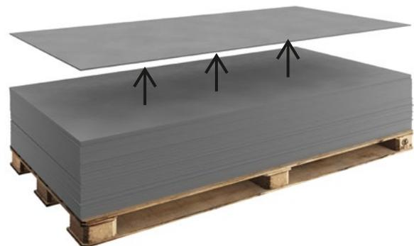
Tafeln nicht vom Stapel herunterziehen, da dies dauerhafte Kratzer hinterlassen kann. Heben Sie die Tafeln an der langen Seite an, um Beschädigungen/Brüche zu vermeiden.
