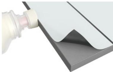
Die Schutzfolie erst nach der Kantenversiegelung, aber vor der Montage entfernen.
