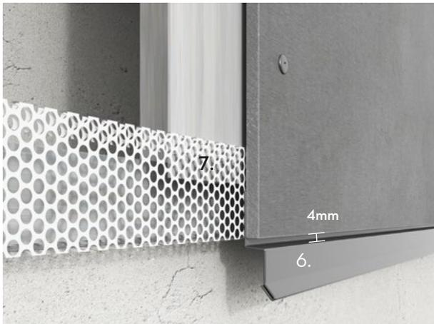
Das Cembrit Tropfblech Profil wird eingesetzt um Wasser von der Fassade abzuleiten. Das Profil kann zusammen mit dem Lüftungsprofil eingesetzt werden um zu verhindern, dass Kleintiere in die Hinterlüftungsebene eindringen. Zwischen der Tafelkante und dem Profil sollten 4 mm Abstand eingehalten werden.
