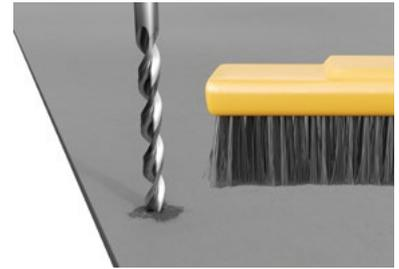
Die Fassadentafeln müssen mit einem für Faserzementprodukten geeignetem Bohrer vorgebohrt werden. Staub vom Schneiden oder Bohren muss gleich entfernt werden, da sonst Spuren auf der Oberfläche zurück bleiben können.
