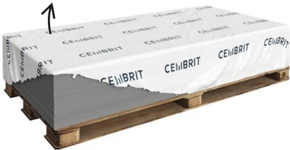
Werden die Paletten im Freien gelagert muss die Kunststoffschutzhülle entfernt werden. Die Fassadentafeln müssen auf Paletten oder auf Lagerhölzern mit einem maximalen Abstand von 500mm gelagert werden.
